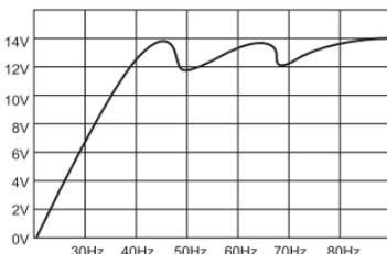
**Bassleistung bei 50Hz und 70Hz mit Pufferkondensator**
